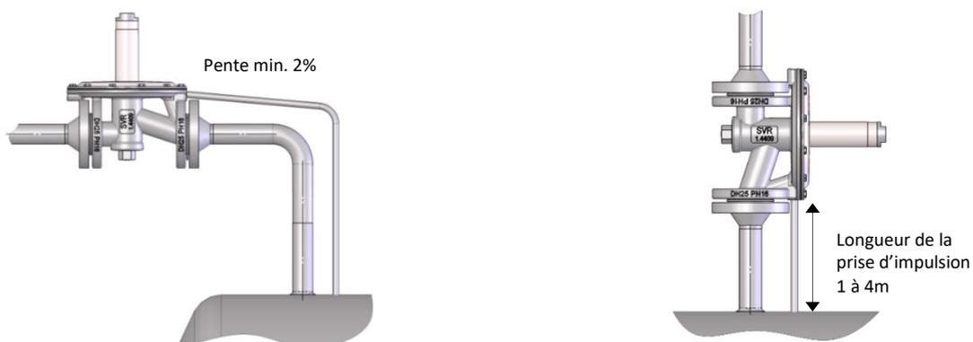
Figure 1: schéma de branchement de la prise d'impulsion
